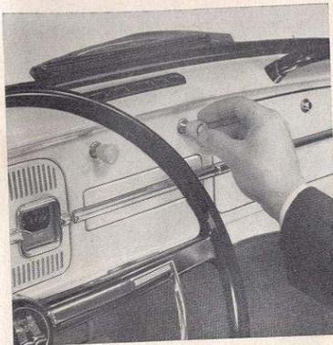
Los limpiaparabrisas se conectan con el interruptor de tiro derecho en el tablero de instrumentos. Después de la desconexión, las rasquetas limpiaparabrisas vuelven automáticamente a su posición inicial.
