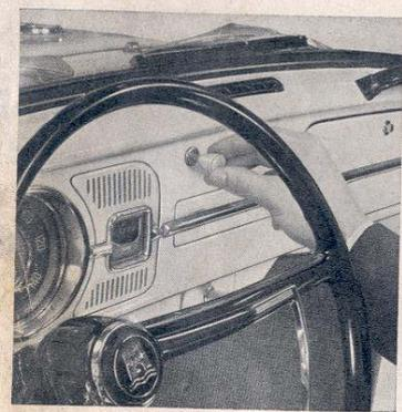
**El alumbrado** se conecta con el interruptor izquierdo de tiro en el tablero de instrumentos. Extrayéndolo hasta la mitad (posición que percibirá Vd. claramente por el encaje en la muesca) se conectan las luces de población, las luces traseras y el alumbrado de la matrícula. Para conectar los faros se extrae el interruptor hasta la segunda muesca. El interruptor para la luz de cruce se halla montado en el interruptor de luces intermitentes en la columna de dirección.
