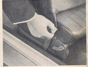
Un dispositivo de bloqueo asegura los respaldos a fin de que no se abatan involuntariamente hacia delante. Para desenclavar y desabatir los respaldos, levántese la palanca inferior.
