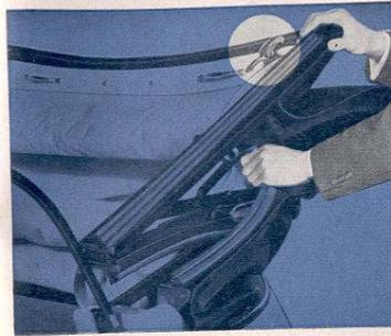
Apretar ligeramente la capota hacia abajo hasta que los pestillos de resorte encajen a derecha e izquierda.
