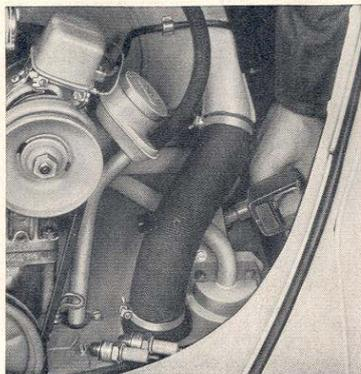
La compresión se mide con el motor a la temperatura de servicio en el asiento de las bujías de los cilindros. Para comprobar la compresión deben desenroscarse las cuatro bujías. Entonces, el motor debe girarse con el motor de arranque, con el acelerador pisado a fondo, hasta que no varíe apenas la indicación en la escala.
