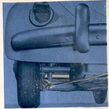
En la parte delantera, el cable de remolque se fija al tubo portante inferior del cuerpo del eje delantero, lo más pegado posible al cabezal del bastidor.
