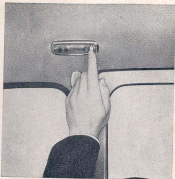
**El alumbrado interior** se encuentra encima de la puerta izquierda. El interruptor de la lámpara tiene tres posiciones:
