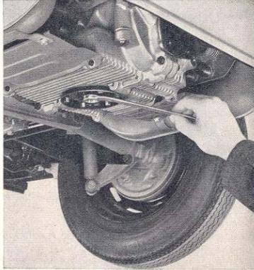
La evacuación del aceite viejo se hace quitando el tapón en la tapa del colador, con el motor caliente. No es necesario el enjuague del motor. Sin embargo, al hacer un cambio de aceite debe desmontarse y limpiarse siempre el colador. Las junta y los anillos de junta de las tuercas deben renovarse también cada vez. A continuación, se llena el motor con 2,5 lts. de aceite HD de marca.
