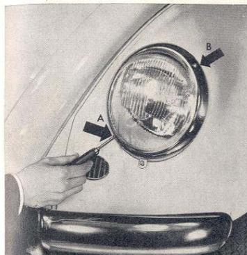
Ajustar los faros por separado con ambos tornillos ranurados en el bisel, con la luz de cruce conectada. Mientras se hace el ajuste de un faro debe taparse el otro.
