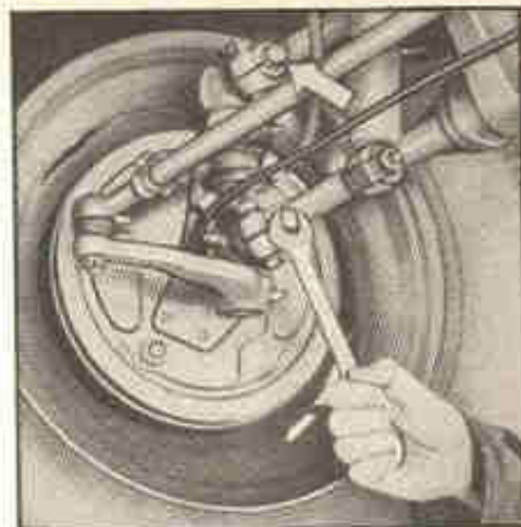
Fig. 7-N — Regulagem dos pinos da suspensão (sedan, Karmann Ghia e utilitários).
