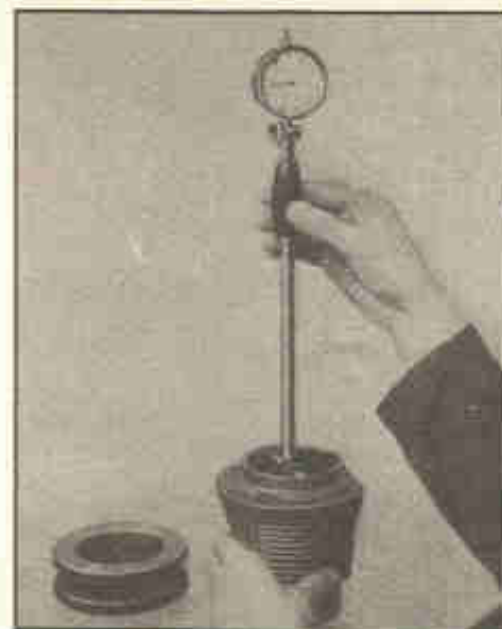
Fig. 22-H — Medida do diâmetro do cilindro. Ao lado, um anel para comparação.
