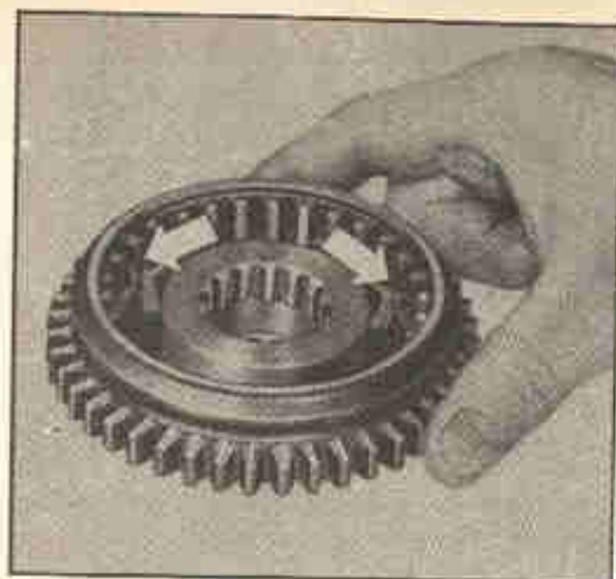
Fig. 8-K — Colocando a manga no corpo do sincronizador de modo que fiquem em alinhamento os entalhes dos retêns com as ranhuras no corpo do sincronizador.
