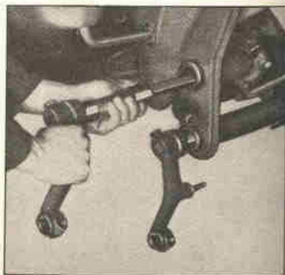
Fig. 5-1. — Modo de se retirar uma barra de torção. A reposição se faz do mesmo modo.
