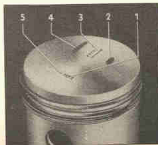
Fig. 18-H — Marcações na cabeça do êmbolo — "1 200":
