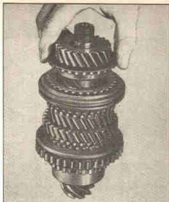
Fig. 8-J — Retirada da engrenagem de 4. a velocidade da árvore secundária.
