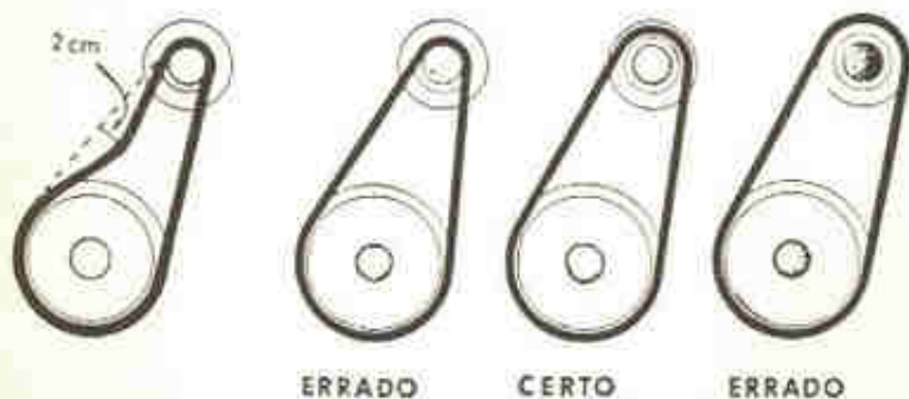
Fig. 4-B — Na figura à esquerda, vemos, de forma exagerada, o ponto onde deve haver uma deflexão de cerca de 2 cm. Vemos também as posições correta e incorretas da correia.
