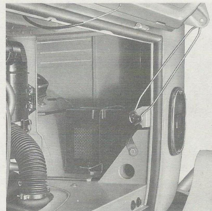
Um apoio, em forma de mola, mantém a tampa do compartimento do motor aberta. Para fechá-la, basta movimentar a tampa para baixo.
