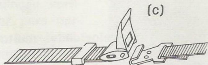
**Regulagem:** Os cintos podem ser regulados (aumentados ou diminuídos), conforme necessidade, bastando para tanto agir no cadorço, estando o fecho a 90° com este. No ajuste do comprimento dos cintos, deve sempre ser ajustada a posição do fixador do cadorço.
