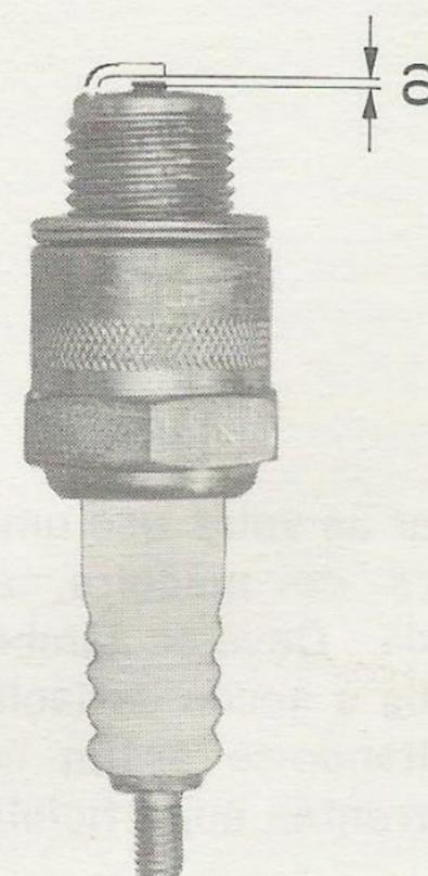
Verifique o afastamento dos elétrodos ( $a = 0,6 - 0,8$  mm) e, se for necessário, torne a regulá-los, dobrando ligeiramente o eletrodo da "massa". Não se esqueça de recolocar os anéis de vedação das velas. A duração média das velas é, em geral, de 15.000 km.
