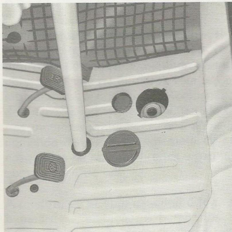
O reservatório deve estar abastecido com 3/4 de sua capacidade. Antes de reabastecer ou verificar o nível do óleo do reservatório, limpe bem a área em volta do bocal de enchimento.
