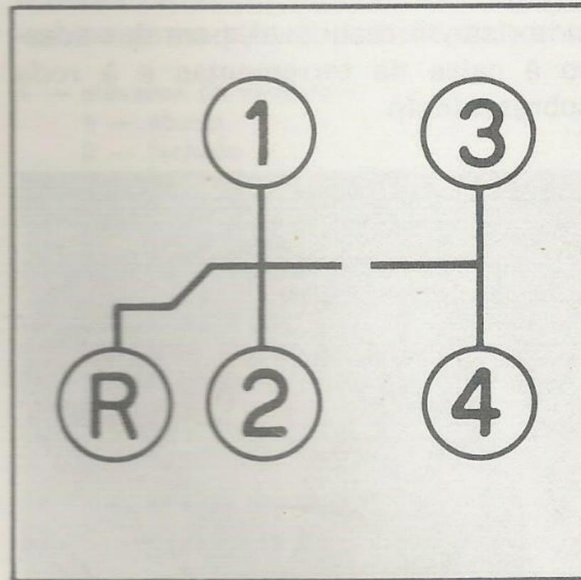
**Atenção:** Ligar somente em terreno derrapante e, ao engatar, soltar lentamente a embreagem. Usar nas 1.<sup>a</sup> e 2.<sup>a</sup> velocidades e na marcha-à-ré. Evitar o uso desnecessário especialmente nas curvas.
