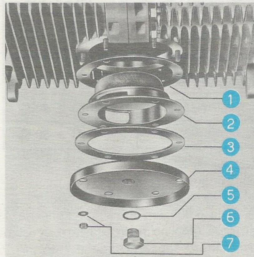
viços de manutenção. As juntas de vedação devem ser substituídas, sempre que o filtro da bomba de óleo for desmontado.
