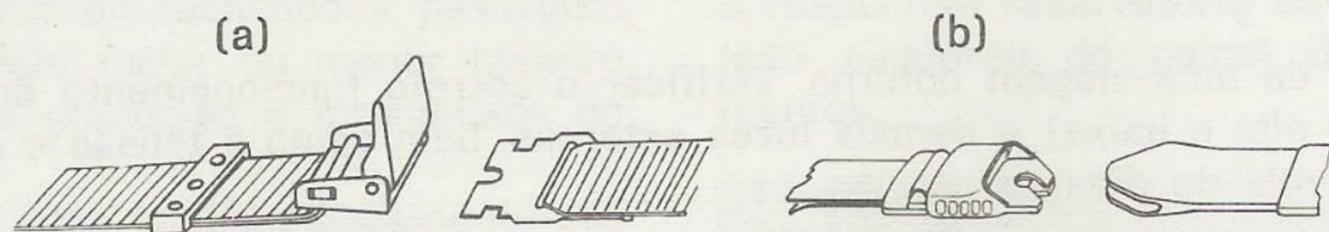
**Fecho magnético:** Para fechar a fivela encaixa-se a extremidade curvada da lingüeta, na parte posterior do fecho. Para abrir, levanta-se a aba do fecho (c).
